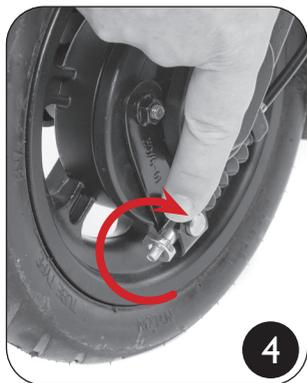
4. Stellen Sie nun die Einstellschraube der Vorderbremse so ein, dass beim drehen des Rades kein schleifendes Geräusch mehr zu hören ist.
