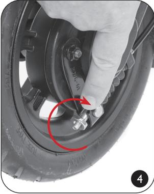
4. Stellen Sie nun die Einstellschraube der Vorderbremse so ein, dass beim drehen des Rades kein schleifendes Geräusch mehr zu hören ist.
