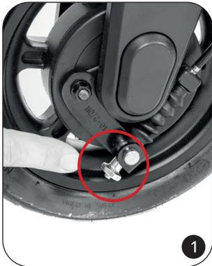
1. Nachdem Sie den Lenker montiert haben, drehen Sie als erstes die Einstellschraube der Vorderbremse gegen den Uhrzeigersinn auf, bis diese plan mit dem Gewinde abschließt.
