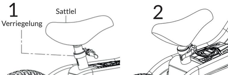
1. Lösen Sie die Verriegelung und stellen Sie den Sattel in die richtige Position.
